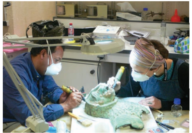
التنظيف بجهاز المايكرو دريل - تنظيف رأس الأسد الأول
